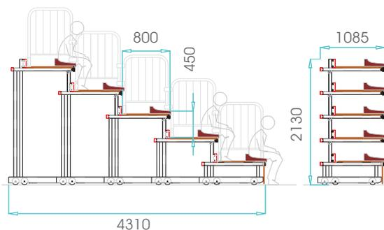
Graderío telescópico con asiento de polipropileno tipo culera o semirespaldo.
