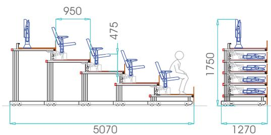
Graderío telescópico con butaca elevable y abatible automáticamente mediante sistema de pistones.
